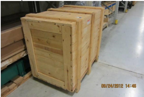
Ejemplo de diseño de cajón aceptable (construcción de madera sólida)
