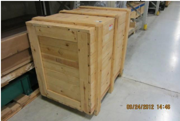
Exemplu de design de ladă acceptabil (structură din lemn masiv)
