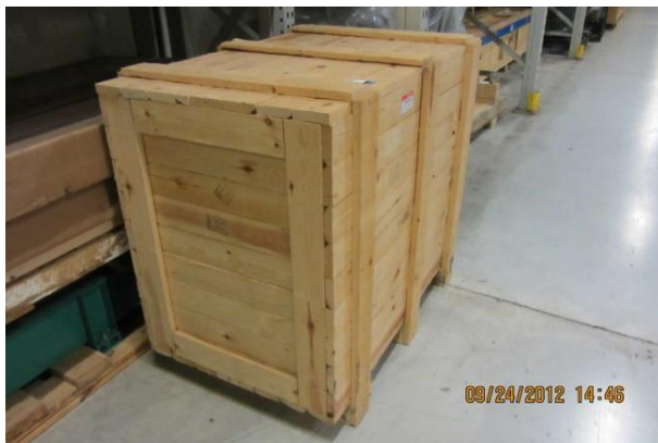
Exemplo de design de engradado aceitável (construção em madeira maciça)
