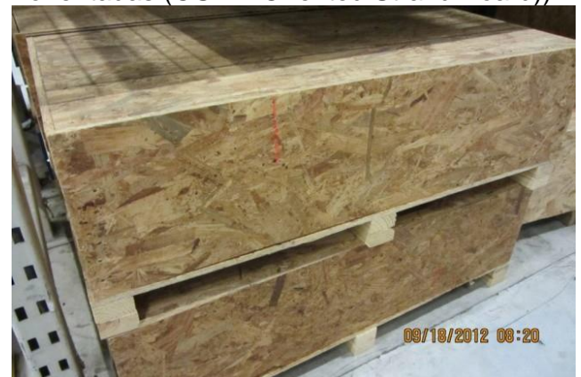
Exemplo de design de engradado de tipo aceitável (construção em placas de fibras orientadas (OSB – Oriented Strand Board))
