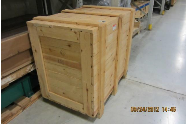
認められるクレート設計(無垢材構造物)の例
